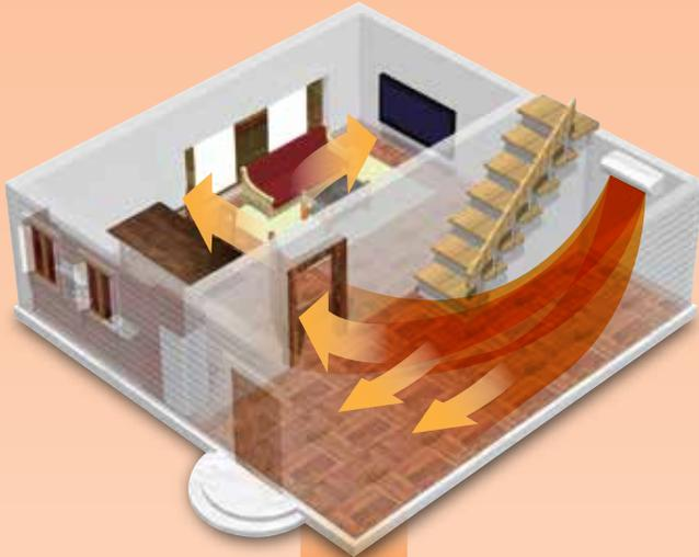
Lorsque la température réglée est atteinte dans la pièce où se trouve l'appareil, celui-ci fait circuler l'air afin d'uniformiser la température dans toutes les pièces.
